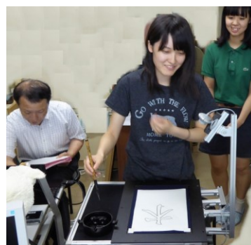
図 10 筆圧の測定の様子
